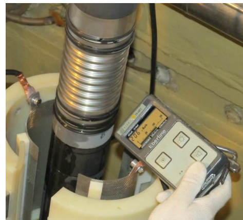
7. ábra: Dózismérés a labirint hornyok dekontaminálása közben
